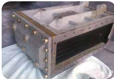
Im Anschluß ist der gereinigte Wärmetauscher wieder bereit für den Einsatz. Eine kostenintensive Neuanschaffung ist nicht erforderlich.
